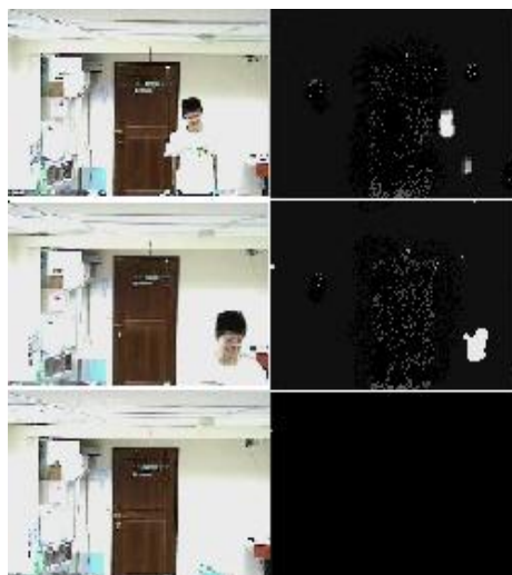
圖七：進行前景物修補後之影像。
