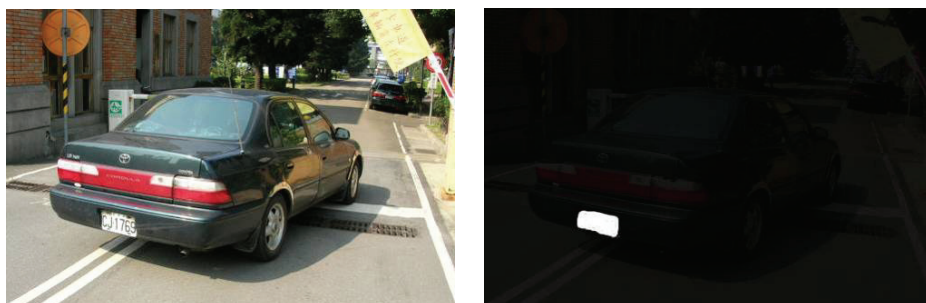
圖十、左圖為輸入影像，右圖為使用 opening 方法，連結區塊的影像
