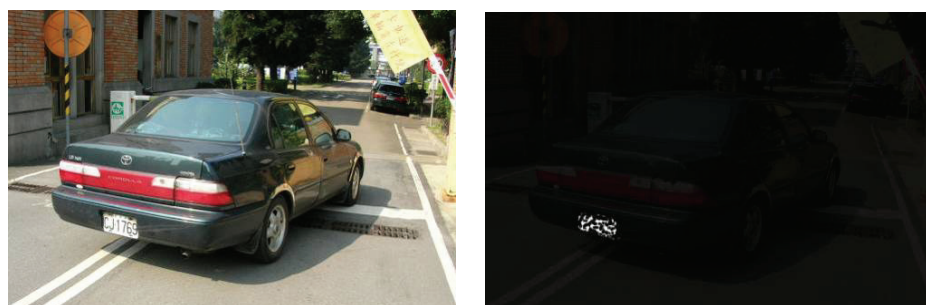
圖九、左圖為輸入影像，右圖為使用 closing 方法，去除雜訊的影像
