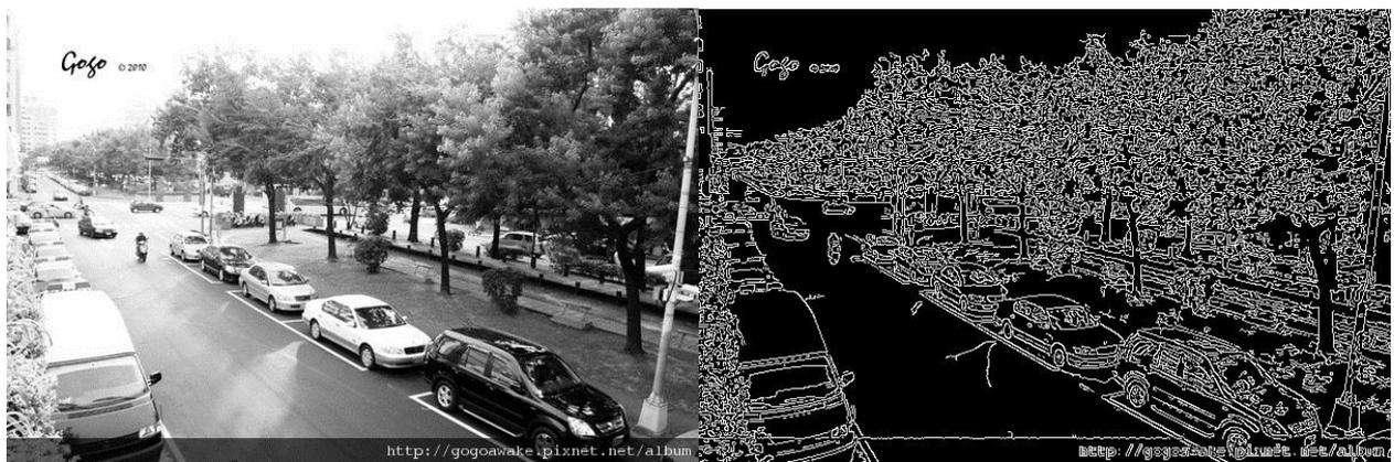
本系統使用的方法，是將原本的影像去與經 Erosion 處理的影像相減，以下為示意圖：
